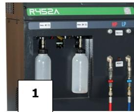
**Note :** À la livraison, les composants internes tels que le compresseur et la pompe à vide sont équipés de leur huile de lubrification. Seule la pompe à vide fera l'objet d'une maintenance régulière.
