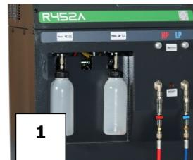
**Hinweis:** Bei der Auslieferung enthalten die internen Komponenten, wie der Kompressor und die Vakuumpumpe, bereits das erforderliche Schmieröl. Nur die Vakuumpumpe muss regelmäßig gewartet werden.
