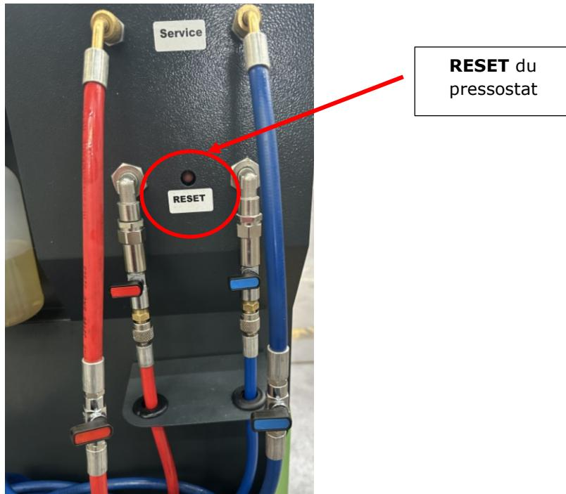
Appuyer ensuite sur le **RESET** du pressostat pour le réenclencher.
