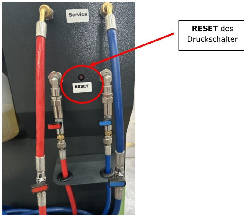
Drücken Sie anschließend die **RESET**-Taste des Druckschalters, um ihn wieder einzuschalten.
