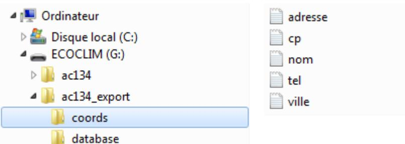
**Hinweis:** Wenn der USB-Stick bereits Dateien mit demselben Namen wie die oben gezeigten enthält, werden diese beim Exportieren von Daten aus dem **RF452** automatisch überschrieben.
