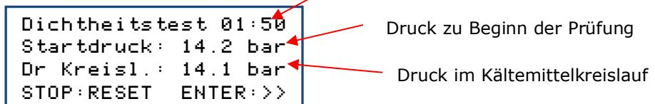
Wenn Sie die Zeit, die der Druck im Kreislauf benötigt, um sich zu stabilisieren, reduzieren möchten, können Sie die Uhr und den anfänglichen Druck im Kreislauf durch Drücken der STOP-Taste zurücksetzen.
