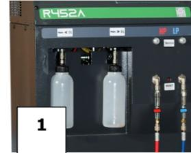
**Nota:** En el momento de la entrega, los componentes internos como el compresor y la bomba de vacío están equipados con su aceite lubricante. Solo la bomba de vacío estará sujeta a un mantenimiento regular.
