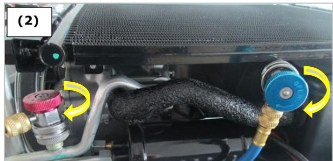
Les manomètres **HP** et **LP** indiquent la pression dans le circuit A/C.
