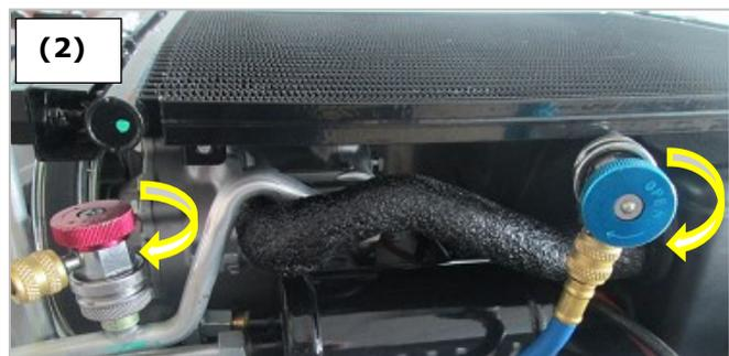
Les manomètres **HP** et **BP** indiquent la pression dans le circuit A/C.
