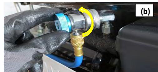
Les flexibles de la station sont isolés du circuit A/C. La station vide le réfrigérant restant dans les deux flexibles.
