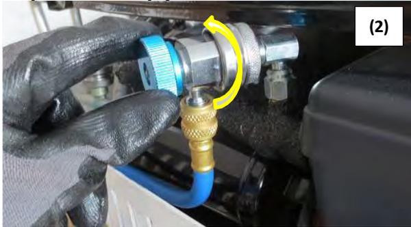
Les flexibles de la station sont isolés du circuit A/C. La station vide le réfrigérant restant dans les deux flexibles.
