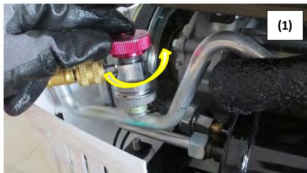
La station ouvre par impulsion ses électrovannes pour faire communiquer les flexibles de haute et basse pression. Le circuit A/C en fonctionnement aspire le réfrigérant. Le nombre d'impulsions restantes figure en bas à gauche de l'écran.
