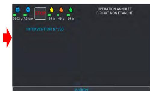
Au cours du **Test d'étanchéité au vide** si la pression du **Circuit A/C** est supérieure à -0.8 bar l'opération de **Test d'étanchéité** s'arrête.
