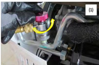
La station ouvre par impulsion ses électrovannes pour faire communiquer les flexibles de haute et basse pression. Le **circuit A/C** en fonctionnement aspire le réfrigérant. Le nombre d'impulsions restantes figure sur l'interface **2**.
