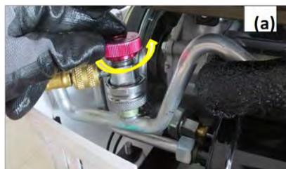
La station ouvre par impulsion ses électrovannes pour faire communiquer les flexibles de haute et basse pression. Le circuit A/C en fonctionnement aspire le réfrigérant. **(5)**
