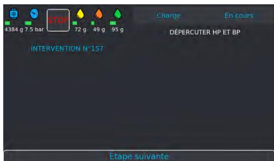
Dévisser les molettes des coupleurs **HP** et **BP** pour isoler les flexibles du circuit A/C. Puis, valider avec **Etape suivante**.
